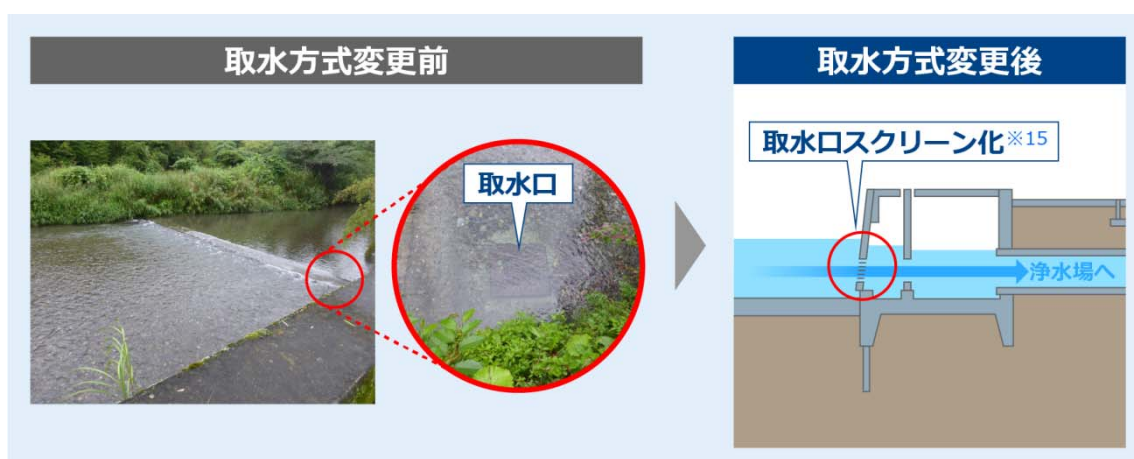
図 3-4 取水方式の変更
