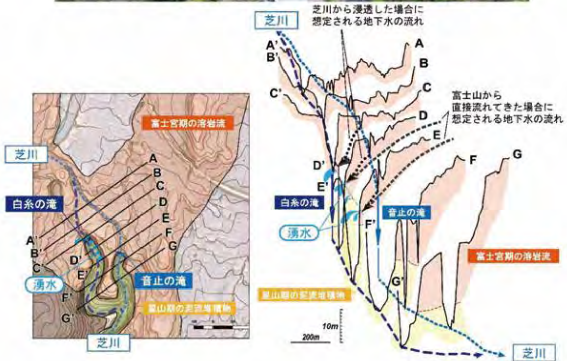
図1-48 白糸の滝および音止の滝周辺の地形・地質断面図と当初想定された地下水の流れ
