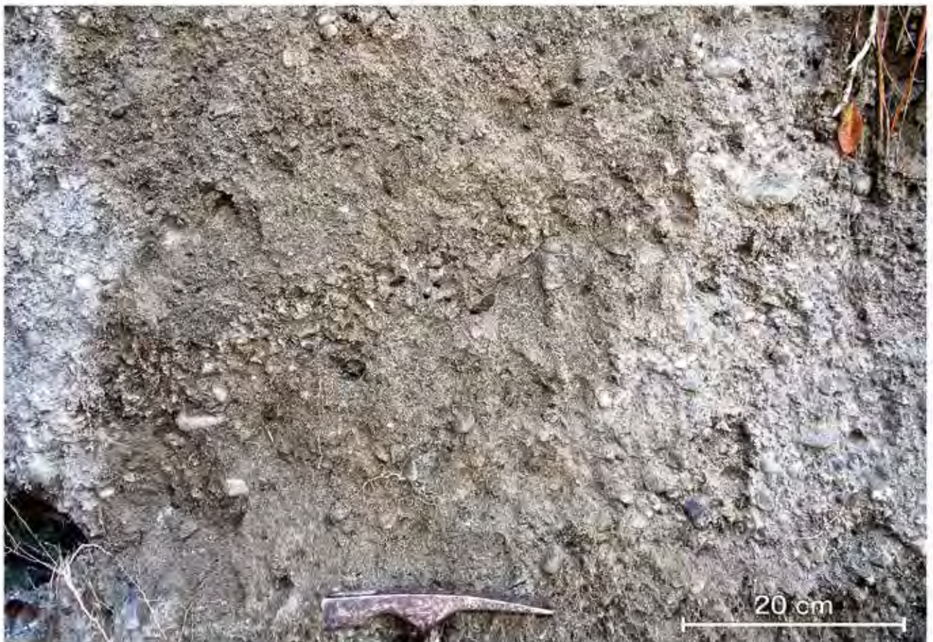
写真1-11 古富士川の河口付近に堆積した鷺ノ田層（星山礫層）の半固結礫層
